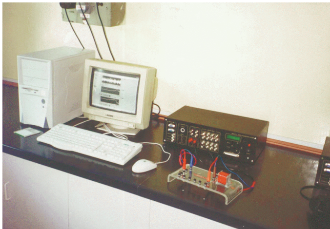
1. ábra. A virtuális mérés technikai hallgatói laboratórium egyik munkaállomása a DAS1414 intelligens adatgyűjtő egységgel.
