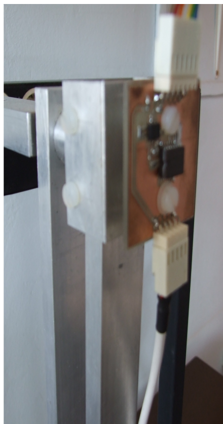
3.3. ábra: A gyorsulásszenzor forgástengely fölé helyezése
