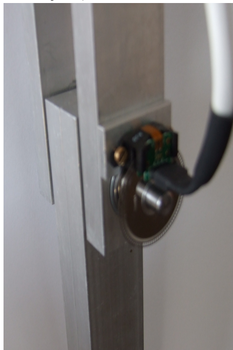
3.4. ábra: Az AEDB 9140 típusú digitális elfordulásmérő az ingára helyezve, védő doboz nélkül.
