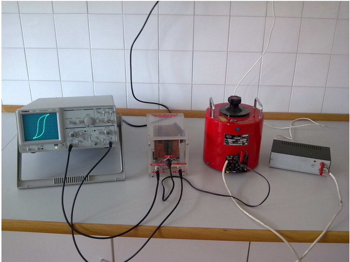
2. kép A régi, harmadéves laboron használt, kísérleti elrendezés legnagyobb tekercsének hiszterézise
