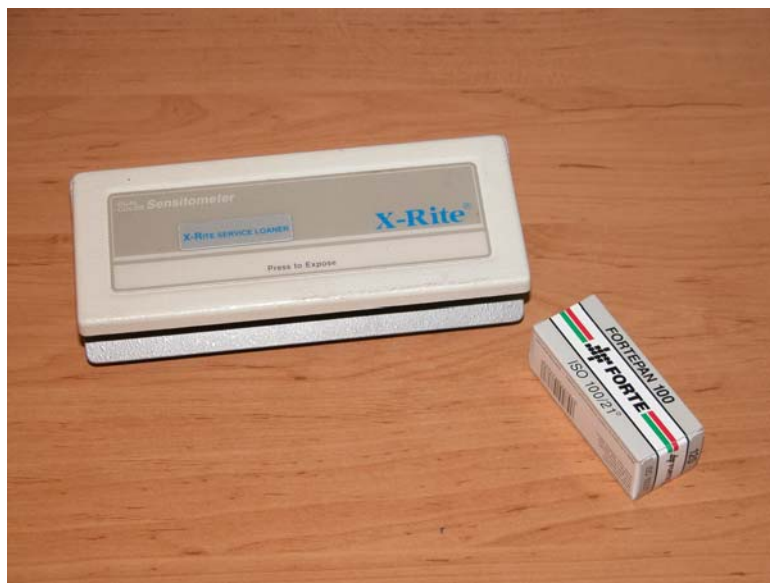
23. ábra Szenzitométer a kalibrálni kívánt filmmel
