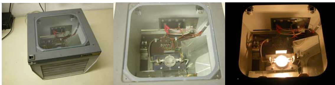
8. ábra Írásvetítőből átalakított levilágító készülék
