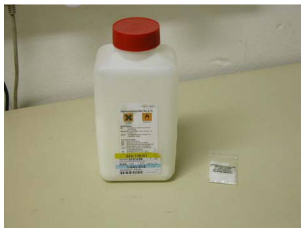
11. ábra A hívó és a maró vegyszer
