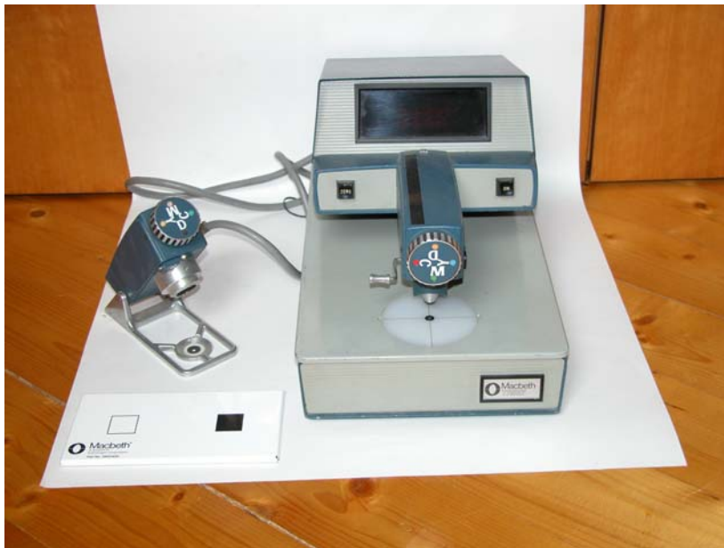
24. ábra Denzitóméter a kalibráló etalonnal és egy előhívott próbacsik
